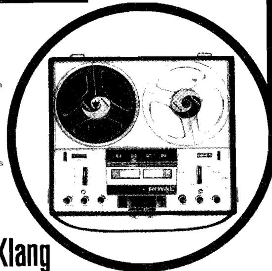
Bei täglicher Benutzung von 2 Stunden reicht ein Batteriesatz ca. 80 Stunden. Die Batterien sind in Ordnung, solange der Zeiger des Kontrollinstrumentes K - bei Drücken der Taste - ausserhalb des geschlossenen roten Feldes steht. Verbrauchte Batterien müssen unbedingt aus dem Gerät entfernt werden. Während längeren Betriebspausen sollten Sie auch neue Batterien herausnehmen.
